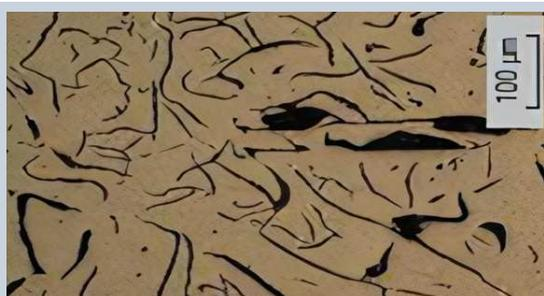
La caratteristica principale di questo materiale è la grafite che si solidifica sotto forma di lamelle, creando discontinuità nella parte ferrosa della lega. Ciò conferisce un effetto autolubrificante, riducendo il "grippaggio", e favorisce la frantumazione in piccolissimi trucioli (quasi polvere) durante la lavorazione. Tuttavia, il materiale presenta mancanza di deformabilità, risultando fragile e con poca capacità di allungamento prima della rottura.
