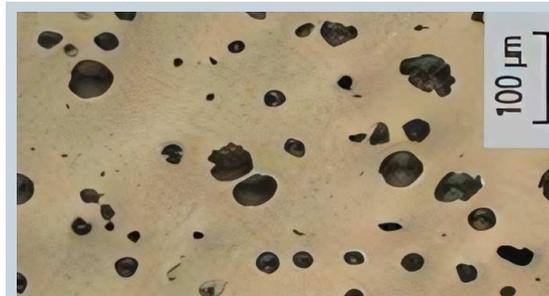
La caratteristica fondamentale di questo materiale è la grafite che si solidifica sotto forma di sferoidi, che conferisce al materiale maggiore resistenza alla trazione, rispetto alla ghisa lamellare, un buon allungamento prima della rottura e una continuità nella parte ferrosa della lega. Tuttavia, limita l'effetto autolubrificante della grafite e genera piccoli trucioli durante la lavorazione, ma senza necessità di sbavatura, come invece accade con gli acciai.
