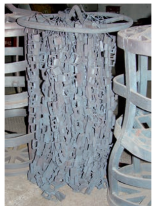
Preparazione per trattamento termico.
